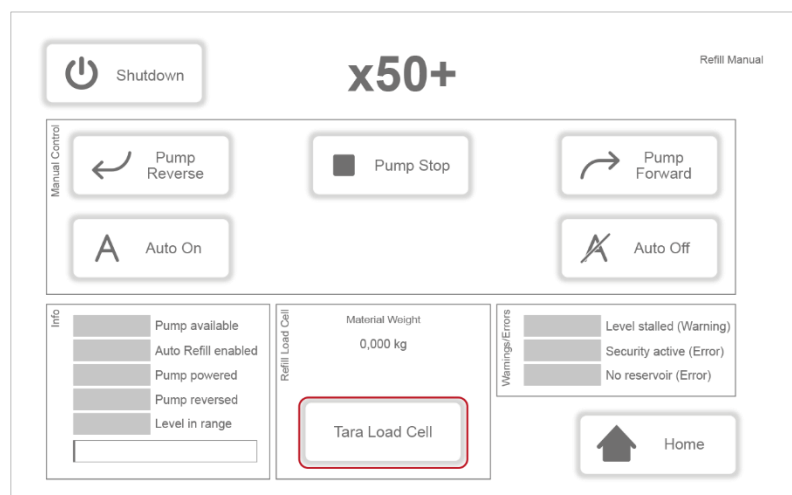
Illustration 24 : Menu Manual Refill, tarer le capteur de pesage
