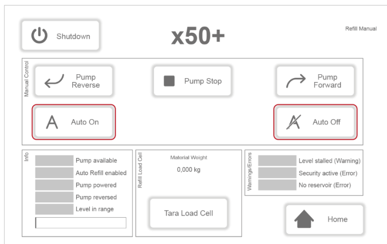
Illustration 40 : Manual Mode, vue d'ensemble « Manual Refill »
