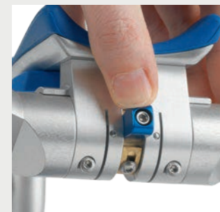
Une relation centrée reproductible garantit une position sûre de départ et d'arrivée pour chaque mouvement. Les défauts de moins de 20 µm peuvent être détectés, contrôlés et éliminés.
