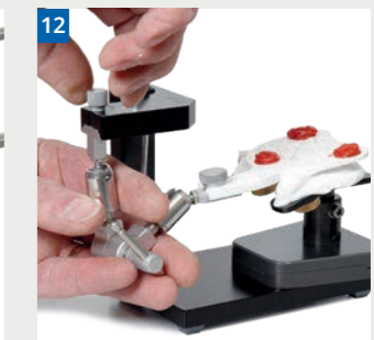
12 Sur la table de transfert, fixer la fourchette dans le lit de plâtre pour garantir un transport sûr, de cette dernière, position figée de la maxillaire, vers le laboratoire dentaire
