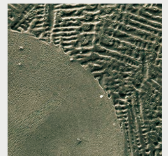
Cordon de soudure laser sans fissures (alliage de coulée CoCrMo sans carbone)
