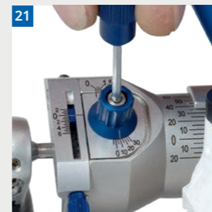
21 Ouverture de la vis de réglage de l'ISS. Remonter la tige incisale
