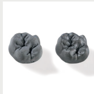
Travaux frittés avec et sans polissage
