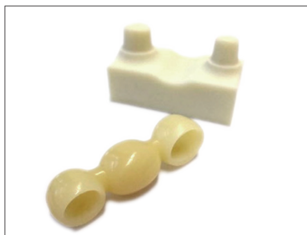
Figure 8 : Géométrie de l'éprouvette pour la simulation de mastication
