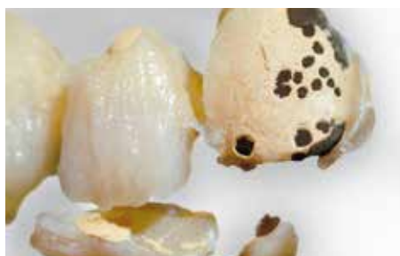
Bulles dans l'opaque dues à une erreur de coulée ou à l'évaporation incomplète de la glycérine
