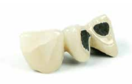
Fêlures et éclats dus à un manque de préparation de l'armature
