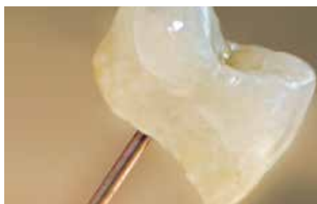
Fissures dans la céramique
