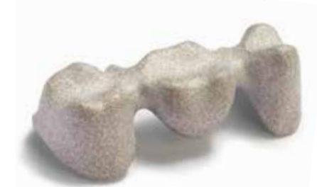
Wirobond® 280 sablé avec Korox® 110 µm
