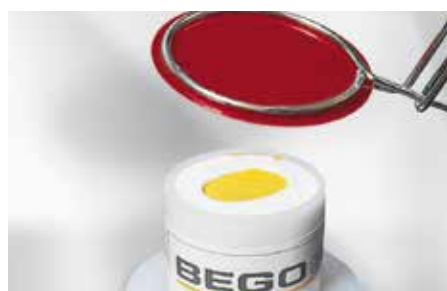
Placer les feuilles devenues malléables sur le dispositif de thermoformage
