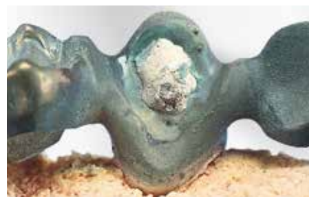
Point de soudure avec soudures Wirobond® ou Wiron® et feuille de platine en sous-couche
