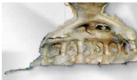
Défauts de coulée
