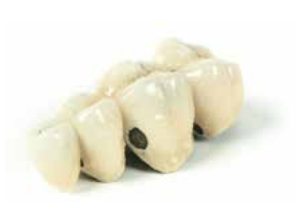
Bulles dans la céramique et cohésion déficiente de la céramique sur l'armature suite à un mauvais séchage de la pâte d'opaque
