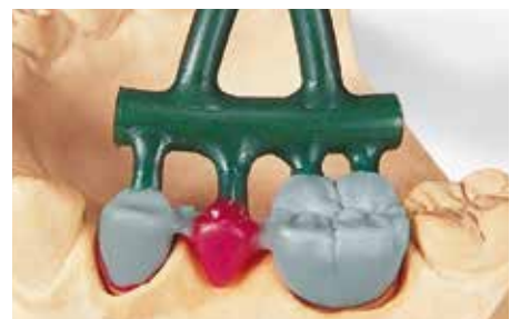
Fil de cire de 4 mm pour un écoulement homogène de l'alliage jusqu'à la tige d'alimentation
